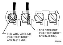
Fig. 4. Proper wiring technique.
